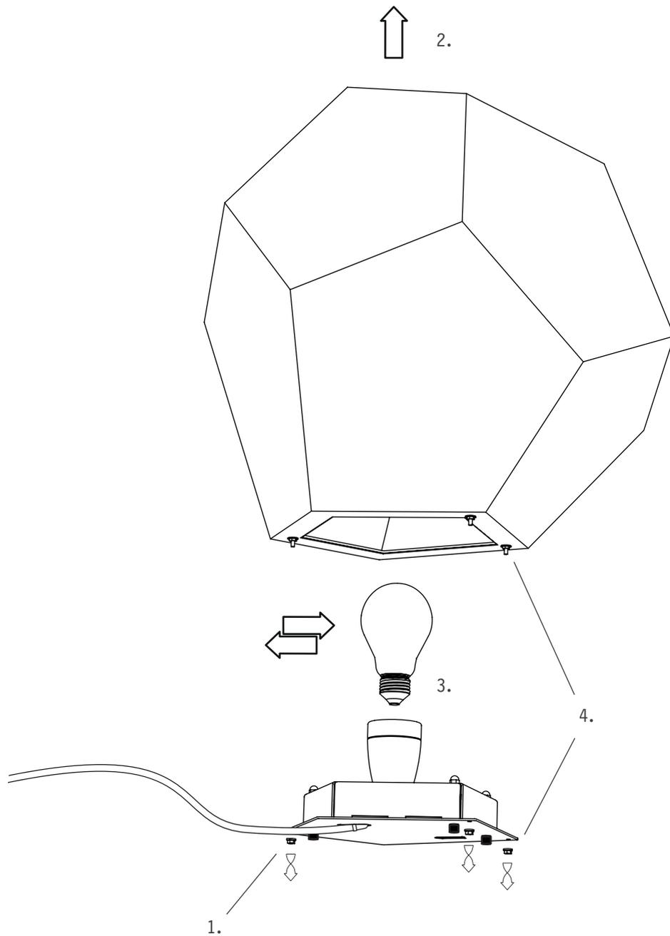
1. Lösen Sie die drei Muttern an der Abdeckung
