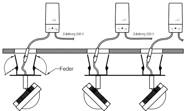
① Für den Deckeneinbau benötigen Sie einen Lochdurchmesser von 68mm und einer Deckenstärke von max. 20mm. Bei sehr dünnen Blechstärken besteht die Gefahr daß die Blechdecke durch die starke Federkraft beschädigt wird.
